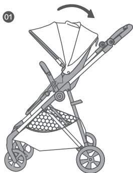
Рис. 14-1. Складывание коляски (шаг 1)
