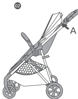
Рис. 14-2. Складывание коляски (шаг 2)
