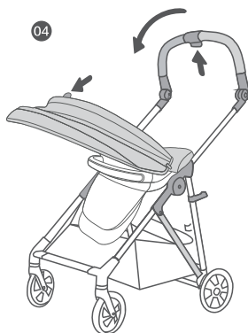
Рис. 14-4: Складывание коляски (шаг 4)
