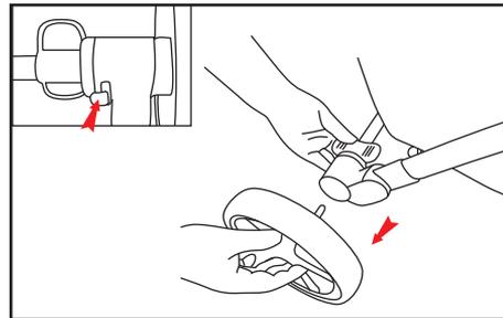
Потянув вверх кнопку, снимите заднее колесо.
