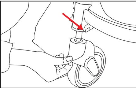
Демонтаж переднего колеса: нажав на кнопку, снимите переднее колесо.
