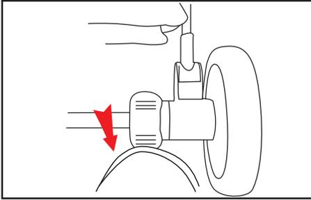
Регулировка тормоза: как показано стрелкой, нажмите на рычаг тормоза назад, чтобы перейти в состояние торможения.
