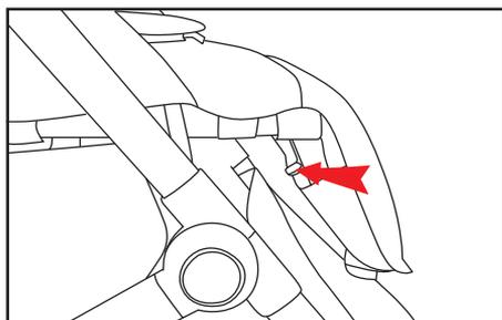
Нажмите кнопки с обеих сторон для регулировки подножки, и опустите в нужное положение
