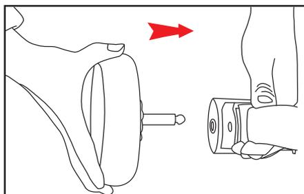
Задние колеса: вставьте ось заднего колеса в соответствующее отверстие.
