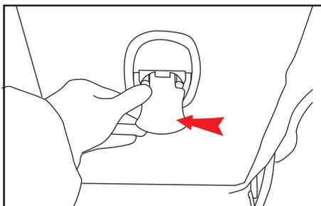
Регулировка спинки сиденья: нажмите кнопку «Регулировки» и потяните ее назад, чтобы опустить спинку сиденья.
